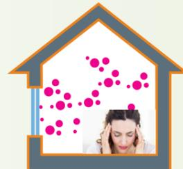
**Schadstoffbewegung in gedämmten Räumen:** Durch die moderne Bauweise können Schadstoffe im Innenraum nicht mehr entweichen und reichern sich dort an.
